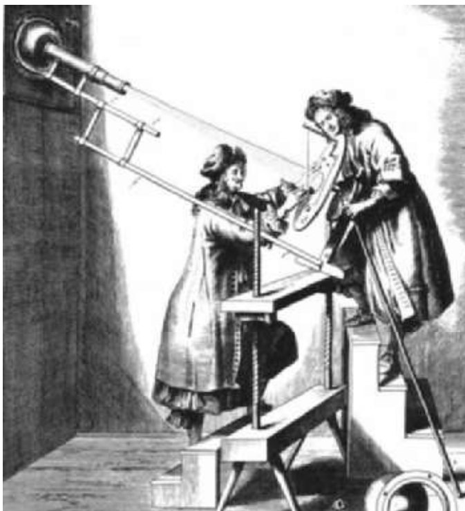
Fig. 9. Telling av solflekker på 1700-tallet: Solens intensitet reduseres og projiseres ved hjelp av et teleskop mot en plate, hvor solflekkene kan tegnes og telles. NB: Det er viktig at man aldri ser direkte mot Solen, for å unngå øyeskade!
